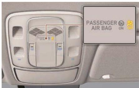
Insérez la clé ou un objet rigide similaire dans l'interrupteur ON/OFF de l'airbag frontal du passager et tournez-la sur la position OFF. Le témoin OFF de l'airbag du passager (☹️) s'allumera et restera allumé jusqu'à ce que l'airbag frontal du passager soit réactivé.
