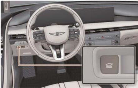
Lorsque le coffre est fermé, maintenez enfoncé le bouton d'ouverture/fermeture du coffre électrique pendant 1 seconde. Le coffre électrique s'ouvre en émettant un signal sonore d'avertissement. Pendant que le coffre s'ouvre, appuyez sur le bouton pour arrêter le fonctionnement du coffre électrique.
