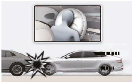
Les airbags frontaux sont conçus pour se déployer lors d'une collision frontale, selon l'intensité de l'impact.
