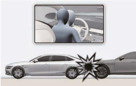
Les airbags frontaux ne sont pas conçus pour se déployer dans les collisions par l'arrière car les occupants sont projetés vers l'arrière par la force de l'impact. Dans ce cas, les airbags déployés n'offriraient aucun avantage supplémentaire.
