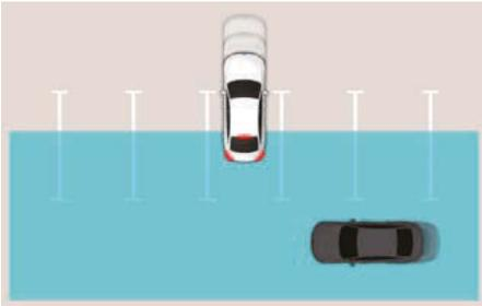
L'aide à l'évitement de collision avec la circulation transversale à l'arrière peut détecter les véhicules qui passent derrière vous lorsque vous vous gardez en marche arrière dans un emplacement. Si cela se produit, la fonction peut activer un avertissement et freiner votre véhicule même si cela n'est pas nécessaire.
