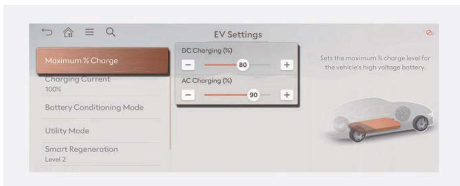
3. Réglez le niveau de charge cible de la batterie pour charger en courant alternatif (CA) et en courant continu (CC).
