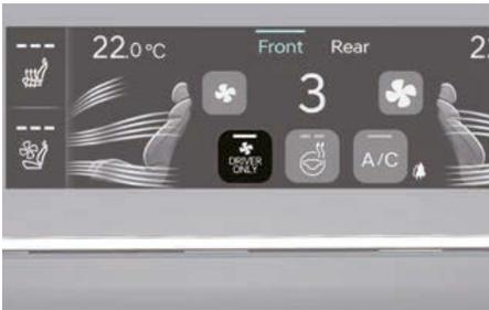
Si vous appuyez sur le bouton **DRIVER ONLY** (conducteur uniquement - témoin allumé), la plus grande partie du flux d'air est dirigé vers le siège du conducteur.
