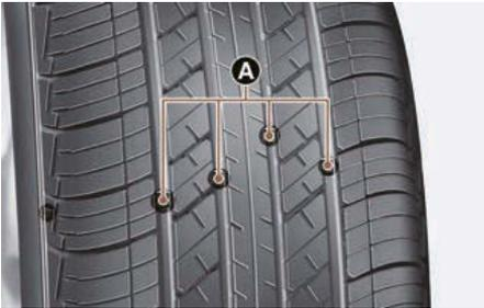
[A] Indicateur d'usure de la bande de roulement
