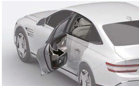
Les portes arrière se ferment automatiquement avec un capteur ou un bouton d'ouverture de porte.
