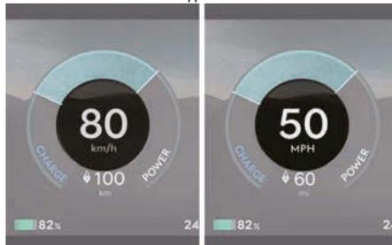
Le compteur de vitesse indique la vitesse du véhicule et il est calibré en
