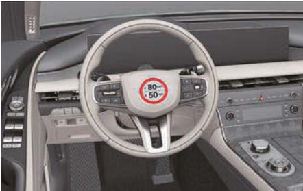
Retirez l'étiquette de limitation de vitesse de la bouteille de produit d'étanchéité et placez-la à un endroit bien visible à l'intérieur du véhicule, par exemple sur le volant, pour rappeler au conducteur de ne pas conduire trop vite.
