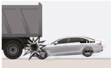
Juste avant l'impact, les conducteurs ont tendance à freiner brusquement. Ce freinage brutal abaisse l'avant du véhicule en risquant de les engager sous un véhicule qui présente une garde au sol plus importante. Les airbags peuvent ne pas se gonfler dans cette situation d'« encastrement » parce que les forces de décélération détectées par les capteurs peuvent être considérablement réduites par ces collisions d'« encastrement ».
