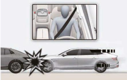
Lors de certaines collisions à vitesse réduite, les airbags peuvent ne pas se déployer. Les airbags sont conçus pour ne pas se déployer dans ce genre de collisions, car ils n'apporteraient pas de sécurité supplémentaire par rapport à celle offerte par les ceintures de sécurité.
