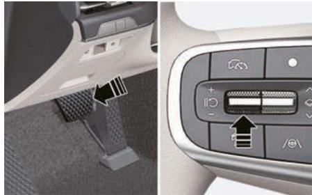
Appuyez sur le contacteur **⊘** ou enfoncez la pédale de frein pour annuler provisoirement le régulateur de vitesse intelligent.
