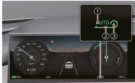
Le combiné d'instruments affiche « AUTO » (1) lorsque le système de récupération intelligente est activé. En fonction des conditions, le système ajuste le niveau de freinage par récupération (2). Le témoin (3) s'allume lorsque le véhicule reconnaît un véhicule.
