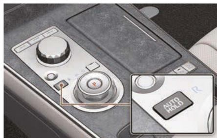
1. Lorsque la porte du conducteur, le capot et le coffre sont fermés, enfoncez la pédale de frein, puis appuyez sur le contacteur **AUTO HOLD**. Le témoin AUTO HOLD blanc s'allume et le système se met en veille.
