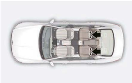
Les ancrages ISOFIX sont placés aux places latérales gauche et droite de la banquette arrière. Leurs emplacements sont indiqués sur l'illustration. Il n'existe
