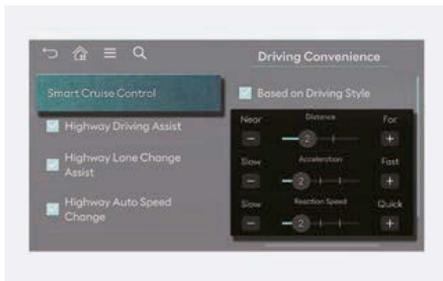
Véhicule allumé, sélectionnez **Configuration > Véhicule > Assistance au conducteur > Confort de conduite > Régulateur de vitesse intelligent (ou SCC (régulateur vitesse intelligent))** dans le menu des paramètres du système
