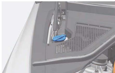
Vérifiez le niveau de liquide du réservoir de lave-glace et ajoutez le liquide nécessaire. Vous pouvez utiliser de l'eau plate si vous ne disposez pas de liquide lave-glace. Mais utilisez un liquide de lave-glace antigel si le climat est froid pour éviter le gel.
