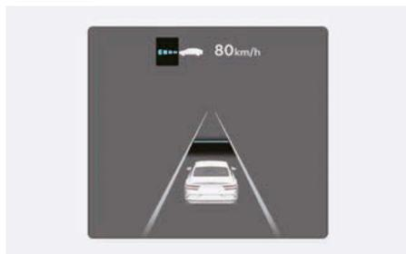
Lorsque Selon le style de conduite fonctionne, le niveau de distance du véhicule et la distance ciblée s'affichent en blanc selon le style de conduite.
