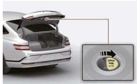
Votre véhicule est équipé d'un levier de déverrouillage d'urgence du coffre situé à l'intérieur du coffre. Si quelqu'un est enfermé par inadvertance dans le coffre, le coffre peut être ouvert en déplaçant le levier dans le sens de la flèche et en poussant le couvercle du coffre pour l'ouvrir.
