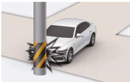
Les airbags peuvent ne pas se déployer en cas de collision avec des objets tels que des poteaux ou des arbres, lorsque le point d'impact est réduit et que l'énergie du choc est absorbée par la structure du véhicule.
