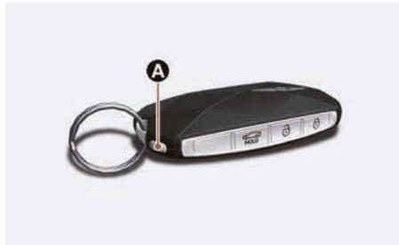
2. Introduisez un tournevis plat dans la rainure intérieure afin de retirer le couvercle de la clé intelligente.
