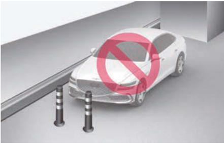
Les performances de l'aide au stationnement intelligent à distance peuvent être réduites ou une collision avec un obstacle peut avoir lieu lorsqu'il y a un pilier étroit, un pilier rond, un pilier carré ou un pilier entouré d'objets comme un extincteur, etc. près de la place de stationnement. Garez le véhicule et sortez de l'emplacement manuellement.
