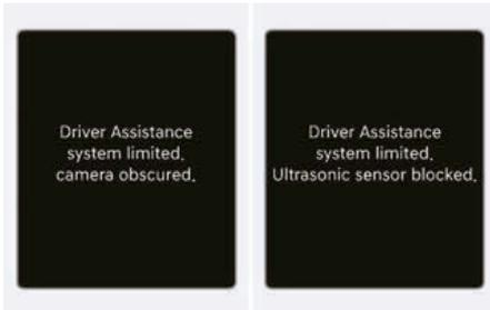
Le message « **Système d'assistance au conducteur limité. Caméra obstruée.** » ou « **Système d'assistance au conducteur limité. Capteur ultrasons bloqué.** » peut apparaître sur le combiné d'instruments, si :
