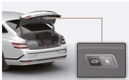
Appuyez sur le bouton de fermeture du coffre électrique. Le coffre se ferme en émettant un signal sonore d'avertissement.
