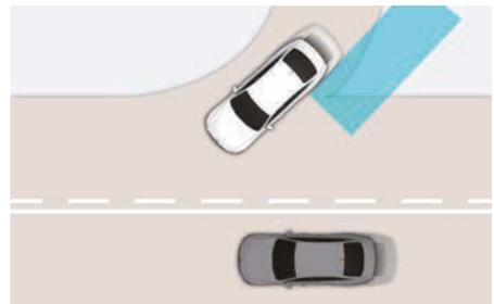
L'aide à l'évitement de collision d'angle mort peut ne pas détecter un véhicule roulant dans la voie adjacente lorsque la route en rejoint une autre ou bifurque
