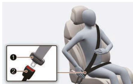
Retirez la ceinture de sécurité de l'enrouleur et insérez la languette métallique (1) dans la boucle (2). Un « clic » se fait entendre lorsque la languette se verrouille dans la boucle. Assurez-vous que la ceinture n'est pas vrillée.
