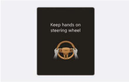
Si vous retirez vos mains du volant pendant plusieurs secondes, le message d'avertissement « **Gardez les mains sur le volant** » (ou « **Placez les mains sur le volant** ») peut s'afficher sur le combiné d'instruments et un signal sonore peut retentir par phases successives.
