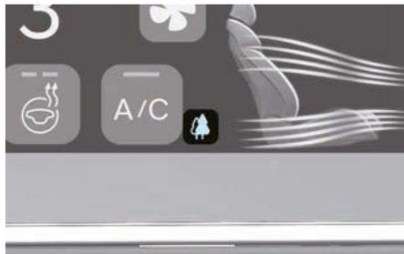
Lorsque le système d'air propre est sélectionné, le taux de poussières fines à l'intérieur est mesuré par le capteur de poussières fines dont est doté le véhicule et le statut de l'air à l'intérieur est présenté à l'écran. Au besoin, il empêche l'air extérieur pollué de pénétrer dans l'habitacle et le filtre à air de l'habitacle purifie l'air intérieur en filtrant les poussières fines afin de délivrer de l'air frais.
