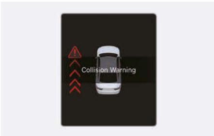
Lorsqu'un véhicule arrivant par l'arrière est détecté au moment où une portière s'ouvre, le témoin d'avertissement peut clignoter sur le rétroviseur latéral, le message d'avertissement « **Avert. collis.** » peut apparaître sur le combiné d'instruments et un signal sonore peut retentir.
