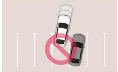
Si l'aide au stationnement intelligent à distance est utilisée lorsque vous vous gardez près d'un véhicule mal aligné, votre véhicule peut dépasser la ligne de l'emplacement du côté opposé du véhicule stationné.
