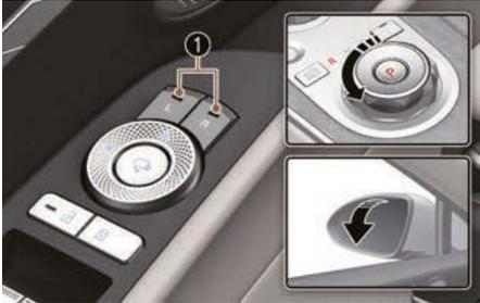
Lorsque le rapport est mis en position R (marche arrière), les rétroviseurs extérieurs pivotent vers le bas pour faciliter la marche arrière.
