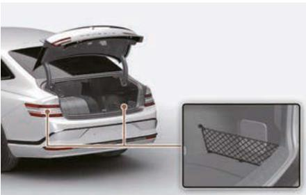
Pour éviter que les objets ne se déplacent dans le coffre, utilisez les 4 attaches situées dans le coffre afin d'installer le filet à bagages.
