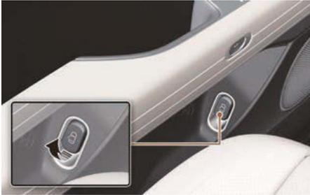
Si la porte ne s'ouvre pas avec le bouton d'ouverture de porte en raison de la décharge de batterie ou de la panne du véhicule, tirez le levier d'ouverture de secours autant que possible sous la poche de portière deux fois pour ouvrir la porte. Vous pouvez utiliser le levier d'ouverture de secours même s'il n'y a aucun problème avec le bouton d'ouverture de porte.
