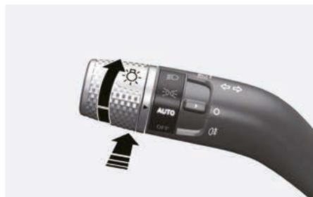
L'assistant phares règle automatiquement les phares entre feux de route et feux de croisement en fonction de la lumière détectée des véhicules venant en sens inverse ou des véhicules précédents grâce à la caméra avant.
