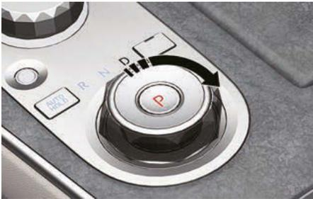
Pour sélectionner la position D (Conduite), tournez le sélecteur rotatif dans le sens des aiguilles d'une montre tout en enfonçant la pédale de frein.
