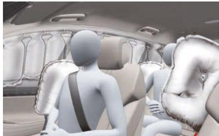
Les airbags latéraux sont situés dans chaque siège avant et sièges extérieurs de la deuxième rangée. De plus, un airbag avant central est prévu du côté intérieur du dossier du conducteur.
