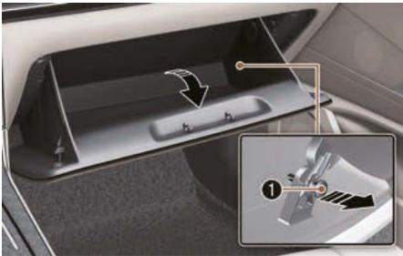
2. Enlevez les butées des deux côtés pour permettre à la boîte à gants de pendre ouvertes.
