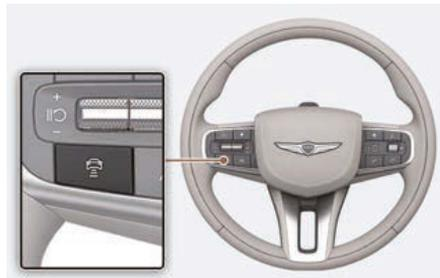
À chaque pression sur le bouton, la distance du véhicule change de la façon suivante :
