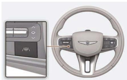
Véhicule allumé, appuyez sur le bouton d'assistance de conduite dans la voie (/⊕) situé sur le volant pour activer l'assistance centre de voie. Le témoin des phares ⊕ s'allume en gris ou vert sur le combiné d'instruments.
