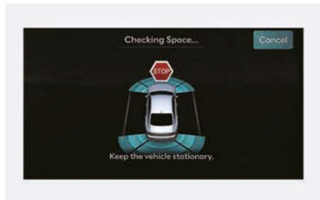
1. Lorsque le véhicule est arrêté en appuyant sur la pédale de frein, les capteurs du véhicule détectent la distance par rapport aux objets à proximité et vérifiez la place pour sortir de l'emplacement.
