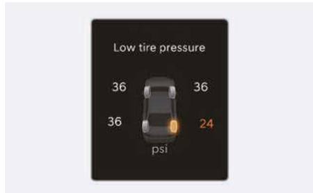
Ce message d'avertissement s'affiche si la pression des pneus est basse. Le pneu correspondant sur le véhicule s'allume.
