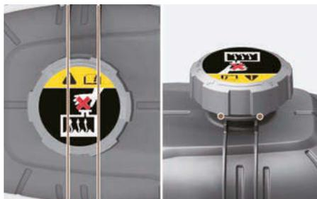
1. Vérifiez que l'étiquette du bouchon du liquide de refroidissement est à l'endroit et bien visible.
