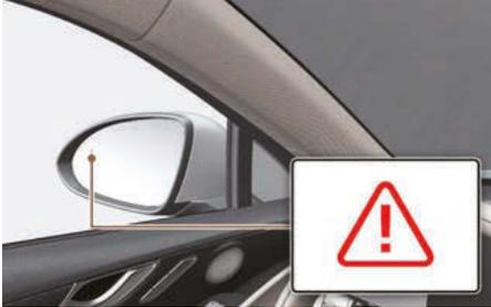
Quand un véhicule est détecté dans un angle mort, le témoin dans le rétroviseur extérieur et l'affichage tête haute (si équipé) peuvent s'allumer.
