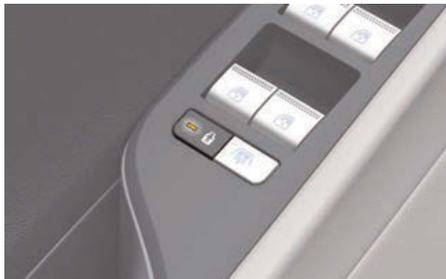
Le conducteur peut désactiver les contacteurs de vitre électrique sur les portes arrière des passagers en appuyant sur le bouton de verrouillage de vitre électrique.
