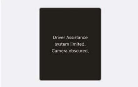
Lorsque la caméra avant est recouverte ou bloquée, le système d'éclairage avant intelligent peut temporairement ne pas fonctionner correctement. Le message « **Système d'assistance au conducteur limité. Caméra obstruée** » peut apparaître sur le combiné d'instruments. Le système fonctionne normalement lorsque ces corps étrangers auront été retirés.
