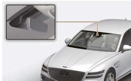
Le capteur de pluie situé à l'extrémité supérieure de la vitre du pare-brise détecte l'importance de la pluie et commande l'intervalle du cycle de balayage.
