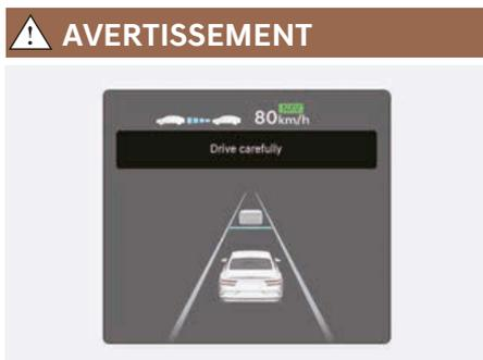
Le message d'avertissement « **Conduisez prudemment** » apparaît si le régulateur de vitesse intelligent basé sur la navigation n'est pas capable de ralentir votre véhicule.
