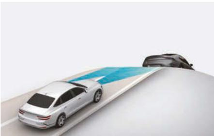
En montée ou en descente, le régulateur de vitesse intelligent peut ne pas détecter un véhicule en mouvement dans votre voie et votre véhicule alors accélérera alors jusqu'à la vitesse programmée. La vitesse du véhicule décélère aussi rapidement
