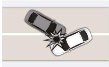
Lors d'une collision angulaire, la force de l'impact peut projeter les occupants dans une direction dans laquelle les airbags ne présenteraient aucun avantage, et les capteurs peuvent donc ne pas les déployer.
