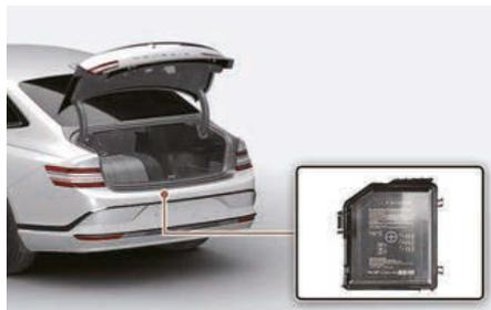
À l'intérieur du couvercle du panneau de fusibles, vous trouverez l'étiquette du panneau décrivant les noms des fusibles/relais et leur calibre.
