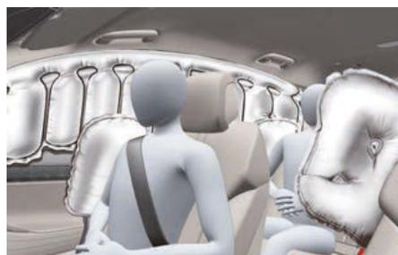
Les airbags latéraux et rideaux et l'airbag avant central se déploient lorsque les capteurs de collision latérale détectent un impact, selon l'intensité de l'impact.
