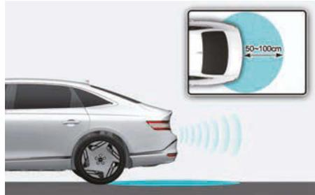
La zone de détection du coffre intelligent s'étend d'environ 50 à 100 cm (20 à 40 pouces) derrière le véhicule. Si vous êtes positionné dans la zone de détection et que vous portez la clé intelligente, les feux de détresse clignotent et le carillon retentit 6 fois pour vous avertir de l'ouverture.
