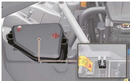
6. Vérifiez le fusible que vous venez d'extraire et remplacez-le s'il a grillé. Des fusibles de rechange sont fournis dans les panneaux de fusible du tableau de bord (ou dans le tableau de fusibles du compartiment moteur).
