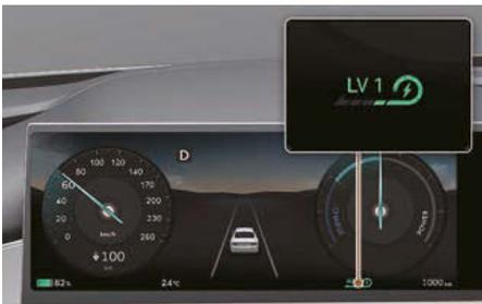
Le niveau de freinage régénératif sélectionné est affiché sur le combiné d'instruments. Lorsque le véhicule est éteint et remis en marche après que le niveau de freinage par récupération ait été abaissé à 0, le niveau de freinage passe à 1.
