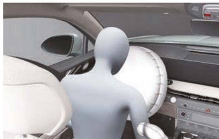
Lors du déploiement, les lignes de rupture du cache se séparent sous la pression du déploiement des airbags.
