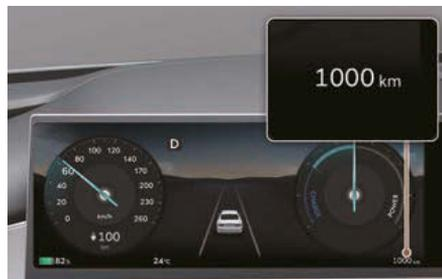
Le compteur kilométrique indique la distance totale parcourue par le véhicule et sert à déterminer à quel moment la maintenance périodique doit être effectuée.
