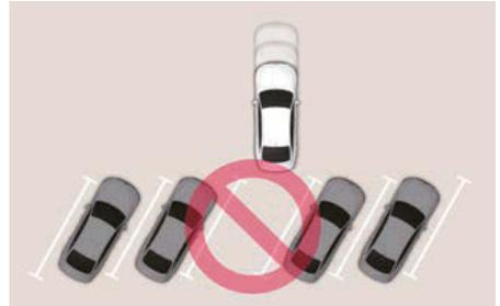
Le fonctionnement à distance peut ne pas fonctionner correctement dans une place de stationnement en diagonale.
