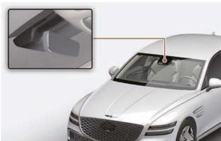
Le désembuage automatique permet de réduire la probabilité de formation de buée sur la face intérieure du pare-brise en détectant le taux d'humidité sur cette face intérieure du pare-brise.
