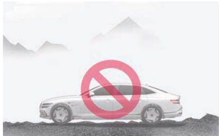
L'aide au stationnement intelligent à distance peut être annulée lorsque le véhicule dérape ou que le véhicule ne peut pas se déplacer en raison de l'état de la route comme des cailloux ou des pierres fragmentées.
