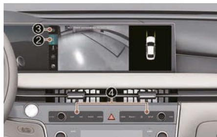
La vue avant s'affiche à l'écran lorsque la position est sur N (point mort) ou D (conduite) pour aider au stationnement. La vue avant a une vue de dessus, une vue avant, une vue latérale et une vue 3D.
