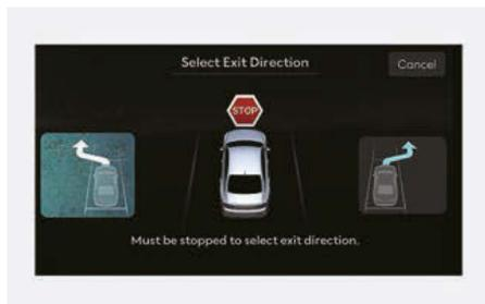
1. Lorsque le véhicule est arrêté à l'aide de la pédale de frein, l'écran du système d'infodivertissement affiche les directions possibles pour une sortie parallèle.
