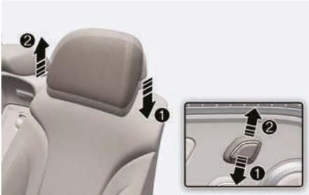
Pour monter et descendre l'appuie-tête : Poussez la commande (2) ou abaissez-la (1) pour ajuster l'appuie-tête vers le haut ou le bas.
