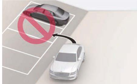
L'aide au stationnement intelligent à distance ne fonctionne pas correctement sur une surface en pente ou en virage. Ne vous gariez pas même si la place de stationnement est reconnue par le capteur.
