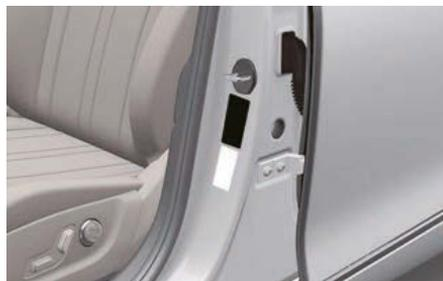
Toutes les spécifications (dimensions et pressions) sont indiquées sur une étiquette apposée sur le montant central côté conducteur.
