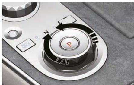
Pour sélectionner la position N (Point mort), tournez le sélecteur rotatif dans le sens des aiguilles d'une montre depuis la position R (Marche arrière) ou dans le sens contraire depuis la position D (Conduite) tout en enfonçant la pédale de frein.
