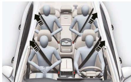
Votre véhicule est équipé de ceintures de sécurité à prétendeur (prétendeur d'enrouleur) pour le conducteur, le passager avant et les passagers arrière (sauf pour le siège central à l'arrière). Le prétendeur s'assure que la ceinture retient fermement la partie supérieure de votre corps lors de certaines collisions frontales. Les ceintures de sécurité à prétendeur peuvent être activées en cas de collision où le ou les chocs frontaux ou latéraux sont suffisamment graves, avec les airbags.
