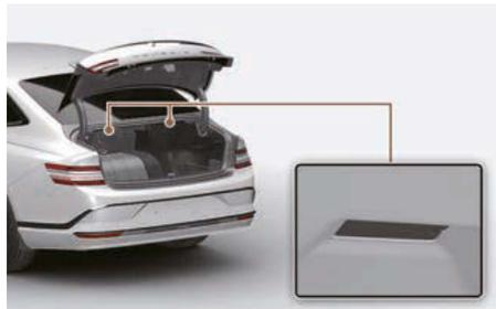
La lampe du coffre s'allume à l'ouverture du coffre et s'éteint à sa fermeture.
