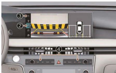
La vue arrière apparaît à l'écran pour vous aider à stationner. La vue arrière a une vue de dessus, une vue arrière, une vue latérale et une vue 3D.
