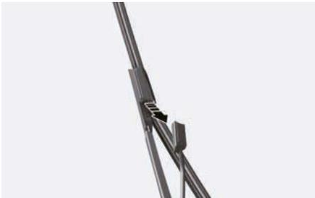
4. Démontez-le en tirant vers le haut tout en appuyant sur la fente (1) placée sur le côté du balai d'essuie-glace.
