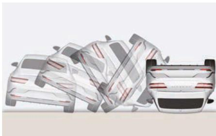
Les airbags peuvent ne pas se déployer en cas de tonneau, car ils pourraient ne pas offrir de protection supplémentaire aux occupants du véhicule.
