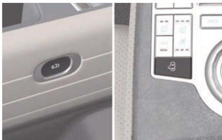
Appuyez sur le capteur de verrouillage/déverrouillage (partie gravée) de la poignée de porte arrière depuis l'extérieur, ou appuyez sur le bouton d'ouverture depuis l'habillage de porte arrière ou encore sur le bouton de fermeture sur la console.
