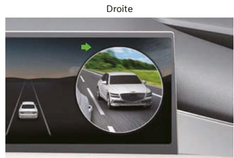
L'affichage de l'angle mort utilise les caméras à large vue latérale pour afficher les zones d'angle mort arrière du véhicule sur le combiné d'instruments lorsque le
