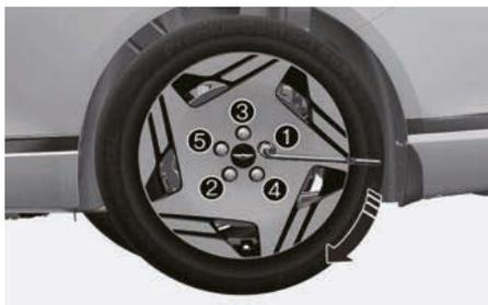
Vérifiez la pression du pneu après avoir monté le pneu de secours compact. Le pneu de secours compact doit être gonflé à 420 kPa (60 psi).
