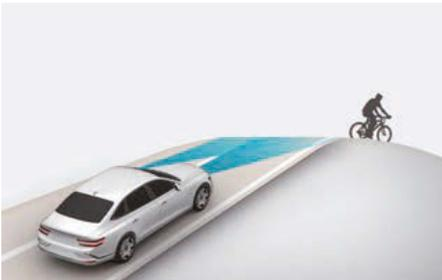
L'assistance à l'évitement de collision avant peut ne pas détecter les autres véhicules, les motards, les piétons ou les cyclistes devant vous lorsque vous arrivez en haut ou en bas d'une côte, ce qui affecte les performances des capteurs. Un avertissement, une aide au freinage ou au braquage (si équipé) peut ne pas s'activer quand vous en avez besoin.
