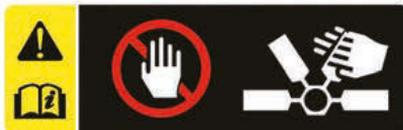
Quand vous utilisez la fonction V2L, le ventilateur de refroidissement du compartiment moteur du véhicule peut se mettre en marche automatiquement, même si le véhicule est coupé. N'approchez pas les mains du ventilateur de refroidissement quand la fonction V2L est activée.
