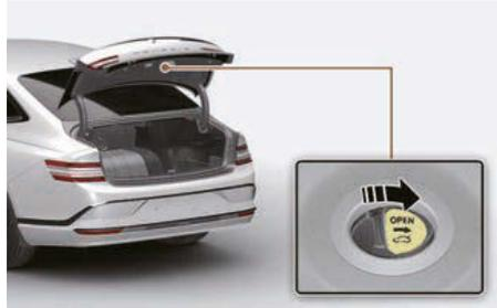
Votre véhicule est équipé d'un levier de déverrouillage d'urgence du coffre situé à l'intérieur du coffre. Lorsque quelqu'un verrouille par inadvertance le coffre, le coffre peut être ouvert en déplaçant le levier dans le sens de la flèche et en appuyant sur le coffre pour l'ouvrir.
