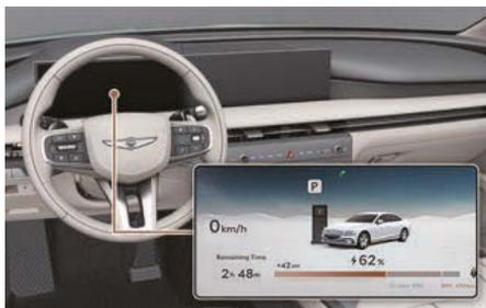
Vérifiez l'état de charge sur le combiné d'instruments pour surveiller la capacité de la batterie haute tension ainsi que la durée de charge estimée. Lorsque la charge commence, l'état de charge s'affichera sur le combiné d'instruments.
