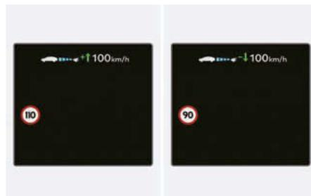
Si la limite de vitesse change lorsque l'assistance de limitation de vitesse manuelle ou le régulateur de vitesse intelligent fonctionne, une flèche allant vers le haut ou vers le bas apparaît pour vous informer que la vitesse réglée doit être changée en appuyant sur le commutateur + ou -.
