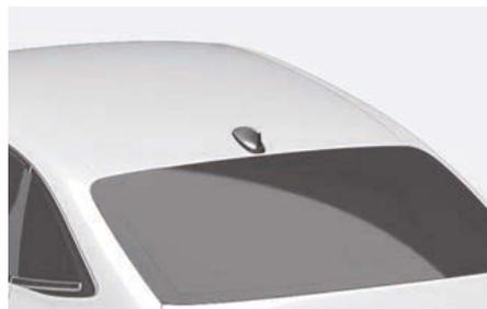
L'antenne en aileron de requin reçoit les données transmises (par exemple, AM/FM).
