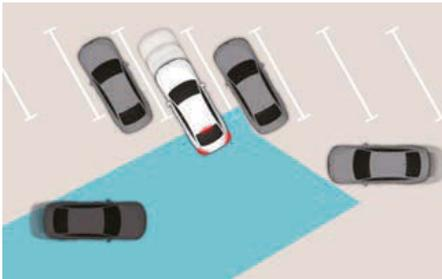
L'aide à l'évitement de collision avec la circulation transversale à l'arrière peut être limitée si vous reculez de biais et peut ne pas détecter un véhicule s'approchant par la gauche ou la droite. Si cela se produit, la fonction peut ne
