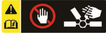
Le moteur électrique du ventilateur de refroidissement peut continuer à fonctionner ou à démarrer lorsque le véhicule ne tourne pas et peut provoquer des blessures graves.
