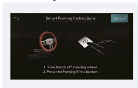
1. Appuyez sur le bouton Vue de stationnement (P) lorsque le véhicule est arrêté en appuyant sur la pédale de frein. Lorsque la pédale de frein est relâchée, l'aide au stationnement intelligent à distance commande automatiquement le volant, la vitesse du véhicule et le levier de changement de vitesse.
