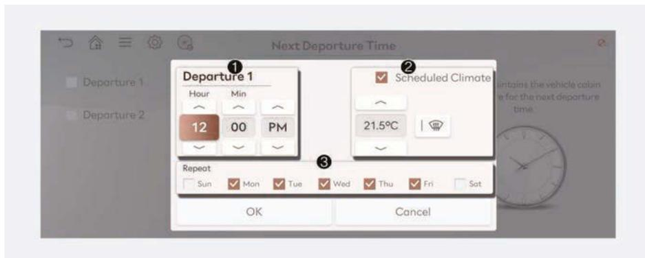
6. La charge et la climatisation programmées s'activent en fonction de l'heure de départ. La climatisation programmée fonctionne 20 minutes avant le départ et 10 minutes après celui-ci.
