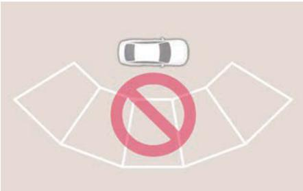
L'aide au stationnement intelligent à distance ne fonctionne pas correctement lorsque les lignes de stationnement ne sont pas parallèles. Ne vous gariez pas même si la place de
