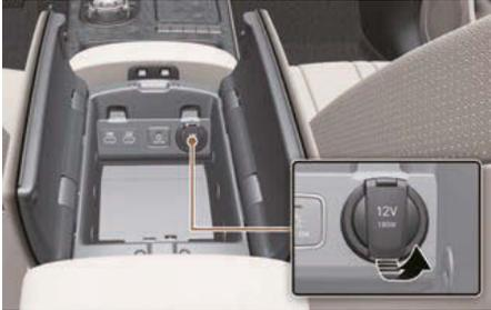
La prise électrique est conçue pour permettre l'alimentation de téléphones portables ou d'autres appareils destinés à être utilisés avec les systèmes électriques du véhicule. Les appareils ne doivent pas consommer plus de 180 watts lorsque le véhicule est en marche.
