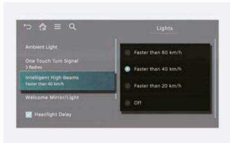
Avec le bouton de démarrage/arrêt en position DRIVE READY, sélectionnez **Configuration > Véhicule > Éclairage > Feux de route intelligents (ou Feu de route intelligent)** depuis le menu des paramètres pour activer le système d'éclairage avant intelligent et désélectionnez pour désactiver le système.
