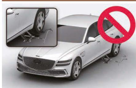
Ne démarrez jamais ou ne faites pas tourner le véhicule sur un véhicule AWD monté sur un cric. Le véhicule peut glisser ou tomber du cric et entraîner des blessures graves ou mortelles.
