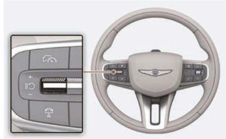
Appuyez sur le contacteur **||O** pour annuler provisoirement la limite de vitesse définie. La limite de vitesse définie se désactive, mais l'indicateur de la limite de vitesse (**LIMIT**) reste allumé.
