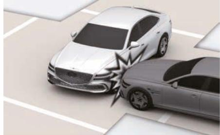
Les airbags frontaux peuvent ne pas se déployer lors de collisions latérales, car les occupants étant projetés dans la direction de la collision, ils n'apporteraient aucune protection supplémentaire en cas de choc latéral.
