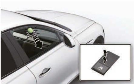
Si une vitre détecte un obstacle pendant qu'elle se ferme automatiquement, elle s'arrête et s'abaisse d'environ 30 cm (12 po) pour permettre de retirer l'objet. Si la vitre rencontre une résistance alors que le commutateur est maintenu en position relevée, elle s'arrête, puis s'abaisse d'environ 2,5 cm (1 po).
