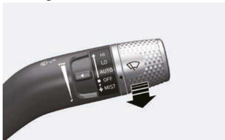
En position **OFF (O)**, tirez doucement le levier vers vous pour pulvériser du liquide lave-glace sur le pare-brise et pour actionner les essuie-glaces pendant 1 à 3 cycles. La pulvérisation de liquide et le
