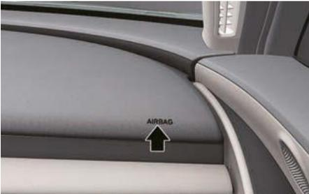
Le système SRS comprend des airbags situés au centre du volant, dans le coussin de planche de bord du côté conducteur sous le volant et sur le panneau avant du côté passager, au-dessus de la boîte à gants.
