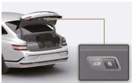
Appuyez sur le bouton de verrouillage du coffre électrique tout en portant la clé connectée. Le coffre électrique se ferme et se verrouille en émettant un signal sonore d'avertissement. De plus, toutes les portes se verrouillent.
