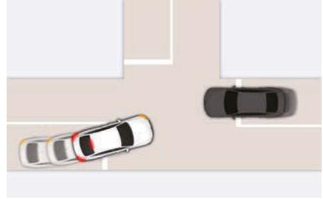
La fonction de Tournant à une intersection aide à éviter une collision avec un véhicule ou un motard venant en sens inverse et tournant à gauche (véhicule à conduite à gauche) ou à droite (véhicule à conduite à droite) dans un carrefour quand le clignotant est activé, en appliquant un freinage d'urgence.
