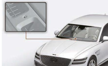
Ne placez aucun objet à proximité du capteur pour garantir un contrôle optimal du système de chauffage et de refroidissement.
