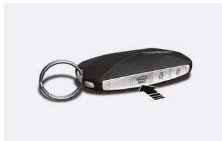
Lorsque le coffre est fermé, appuyez et maintenez enfoncé le bouton d'ouverture/fermeture du coffre électrique pendant 1,5 seconde. Le coffre s'ouvre en émettant un signal sonore d'avertissement.
