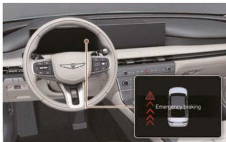
Pour vous avertir d'une collision potentielle, le témoin dans le rétroviseur extérieur et l'affichage tête haute (si équipé) peuvent clignoter, un message d'avertissement peut apparaître sur le combiné d'instruments, un avertissement sonore peut retentir et le volant peut vibrer.
