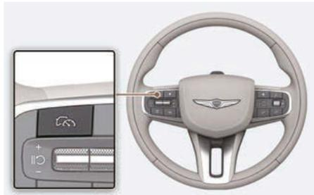
Appuyez sur le bouton d'assistance à la conduite (LIM) pour désactiver l'assistance de limitation de vitesse manuelle. L'indicateur de limite de vitesse (LIMIT) est éteint.
