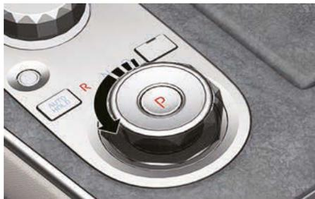
Pour sélectionner la position R (Marche arrière), tournez le sélecteur rotatif dans le sens contraire des aiguilles d'une montre tout en enfonçant la pédale de frein.
