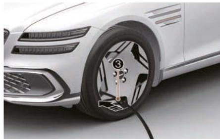
3. Branchez le cordon d'alimentation du compresseur (5) à la prise électrique du véhicule.
