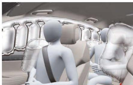
Les airbags rideaux sont situés des deux côtés des longerons de toit, au-dessus des portes avant et arrière.
