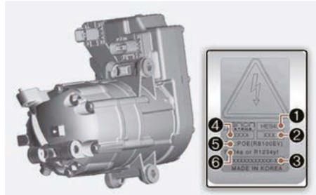
Une étiquette indique le type de compresseur de votre véhicule, notamment le modèle (1), le numéro de série (2), la référence fournisseur (3), le numéro de lot (4), l'huile réfrigérante (5) et le réfrigérant (6).
