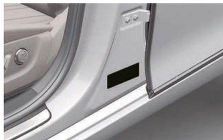
L'étiquette d'homologation du véhicule est apposée sur le montant central latéral côté conducteur (ou côté passager avant). Elle indique par ailleurs le numéro VIN du véhicule.
