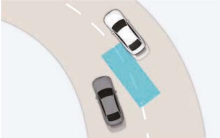
L'aide à l'évitement de collision d'angle mort peut ne pas détecter un véhicule roulant dans la voie adjacente lorsque vous conduisez sur une route sinueuse et peut ne pas activer d'avertissement ni freiner votre véhicule.
