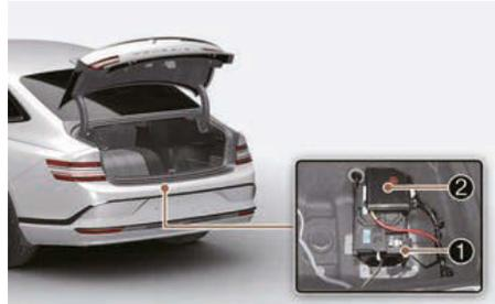
Pour remplacer la batterie, débranchez le câble négatif (-) (1) et déposez le boîtier à fusibles du positif (+) de la batterie (2).
