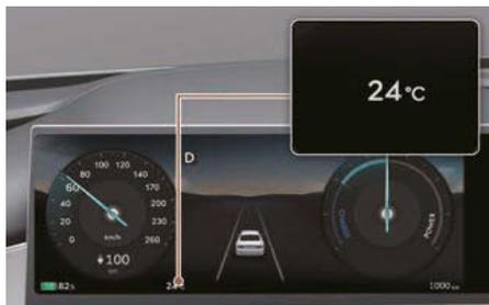
La température ambiante extérieure s'affiche dans la partie inférieure de l'écran du combiné. La température est lue en Celsius ou en Fahrenheit selon les unités sélectionnées depuis le menu des paramètres dans le système d'infodivertissement.
