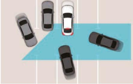
L'assistance à l'évitement de collision avec la circulation transversale à l'arrière peut détecter des véhicules qui se garent ou quittent un emplacement à proximité de votre véhicule (par exemple, un véhicule qui s'en va à côté du vôtre, un véhicule qui se gare ou quitte un emplacement à l'arrière, un véhicule qui approche du vôtre en tournant). Si cela se produit, la fonction peut activer un avertissement et freiner votre véhicule même si cela n'est pas nécessaire.
