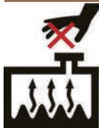
Vérifiez le niveau de liquide de refroidissement après que le compartiment moteur a refroidi. Le niveau de liquide de refroidissement est influencé par la température. Si le bouchon du réservoir de liquide de refroidissement est déposé alors que la température du liquide est élevée, du liquide de refroidissement et de la vapeur chauds pourraient être projetés sous pression et provoquer de graves blessures.
