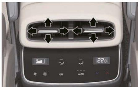
Le flux d'air des aérations du tableau de bord peut être dirigé vers le haut/bas ou vers la gauche/droite à l'aide du levier de réglage des aérations.
