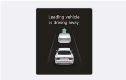
Lorsque le véhicule de devant détecté quitte l'arrêt, l'alerte de démarrage du véhicule précédent affiche le message « **Le véhicule de tête démarre** » (ou « **Le véhicule de tête avance** ») dans le
