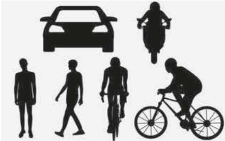
L'illustration ci-dessus montre l'image que la caméra et le radar avant sont capables de détecter comme étant un véhicule, un motard, un piéton et un cycliste.
