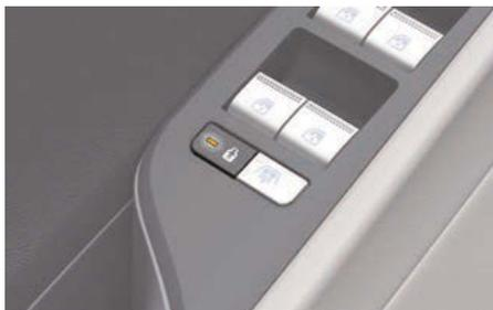
Lorsque le bouton de verrouillage électronique de sécurité pour enfants est enfoncé et que le témoin lumineux du bouton s'allume, les portes arrière ne peuvent pas être ouvertes de l'intérieur du véhicule.
