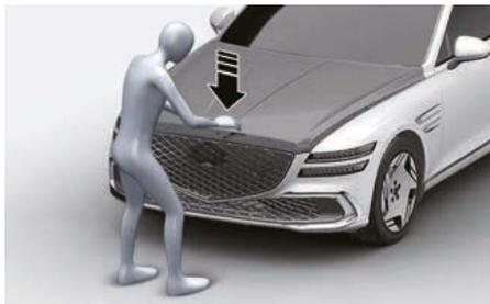
3. Vérifiez que le capot a été correctement verrouillé. Si le capot est légèrement levé, ouvrez-le de nouveau puis laissez-le retomber d'un peu plus haut. Vérifiez une nouvelle fois.
