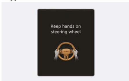
Si vous retirez les mains du volant pendant plusieurs secondes, le message « **Gardez les mains sur le volant** » peut s'afficher sur le combiné d'instruments et un signal sonore retentit par phases.
