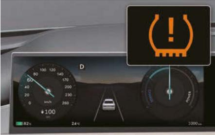
Le témoin de dysfonctionnement du système TPMS s'allume après avoir clignoté pendant environ une minute en cas de problème sur le système de contrôle de la pression des pneus.
