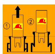
④ Ouvrez le couvercle du boîtier de fusibles en portant un casque ignifuge et tirez sur le commutateur de coupure haute tension
