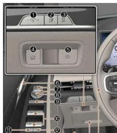
① Pour les véhicules à transmission automatique, appuyez sur le bouton P tout en appuyant sur la pédale de frein pour mettre le véhicule en position de stationnement.
