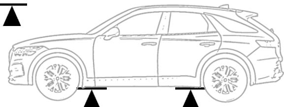
Pour stabiliser le véhicule, utilisez des cales en bois ou similaires aux quatre points de levage
